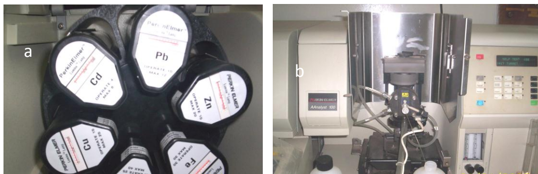
Figure 28 : (a) Lampe de type HCL pour le Cd, le Zn le Cu le Fe et le Pb, (b) Spectrophotomètre d'Absorption Atomique A.ANALYSTE 100 photo prise par BENADDA h., 2016.
