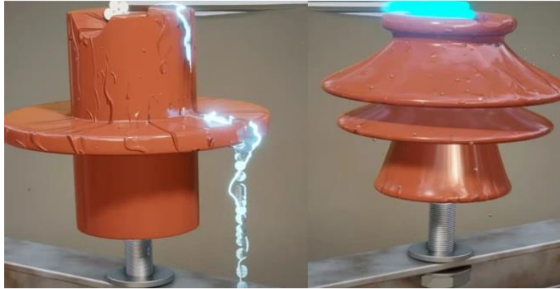
Figure (III. 12) : Arc électrique dans les traversé du transformateur
