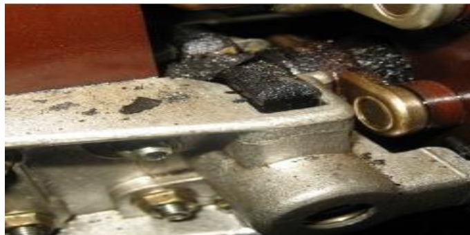
Figure (III. 16) : Point chaud du régleur [43]
