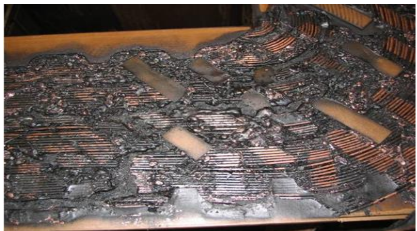
Figure (III .2) : Court-circuit entre spire [19]
