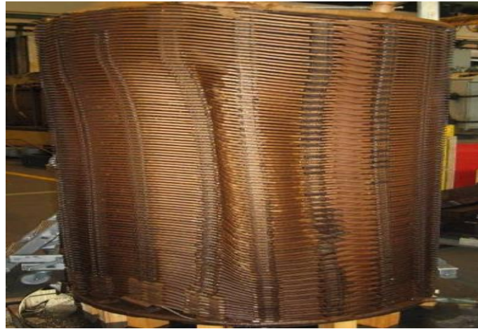
Figure (III.10) : déplacement des enroulements [19]
