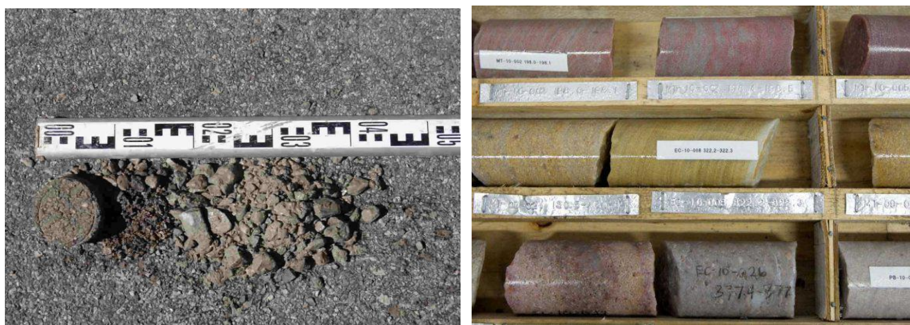
Figure 56 : exemple d'un essai de carottage.
