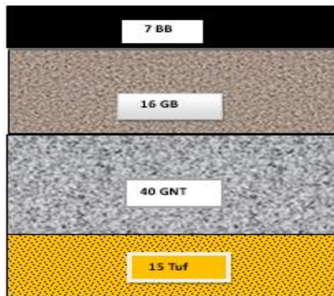
Figure n°43: Les couches de corps de chaussée.
