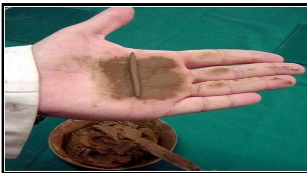
Figure N°66 : limite de plasticité.
