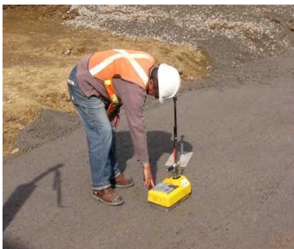
Figure n °54: L'appareil de compacité (nucléo-densimètre).
