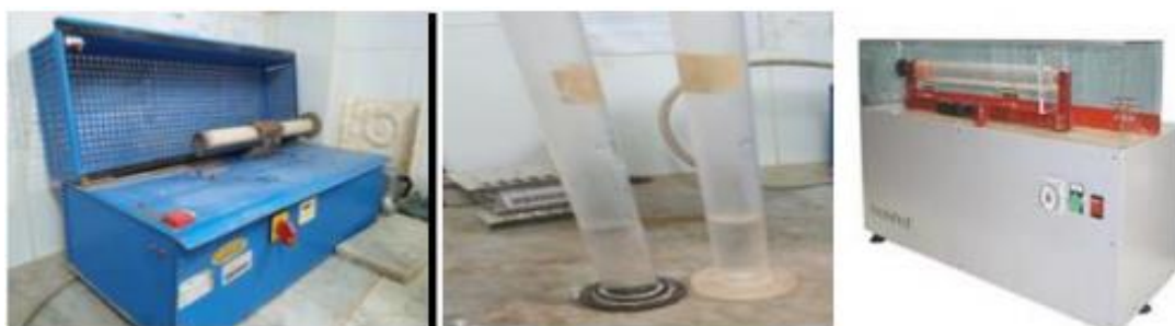
Photo n° 63: Matériels utilisés dans l'essai équivalent de sable.
