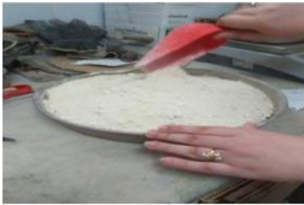
Figure N°68 : Tamisage de l'échantillon.
