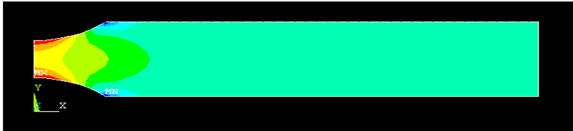
Figure II-15. Zone critique due au chargement de traction monotone
