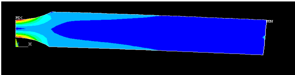
Figure II-16. Zone critique due au chargement de flexion alternée
