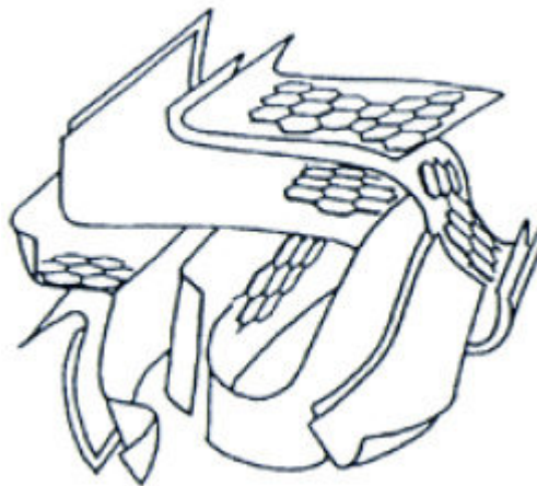
Figure III.2 : Modèle schématique de la structure d'un charbon actif. [37]
