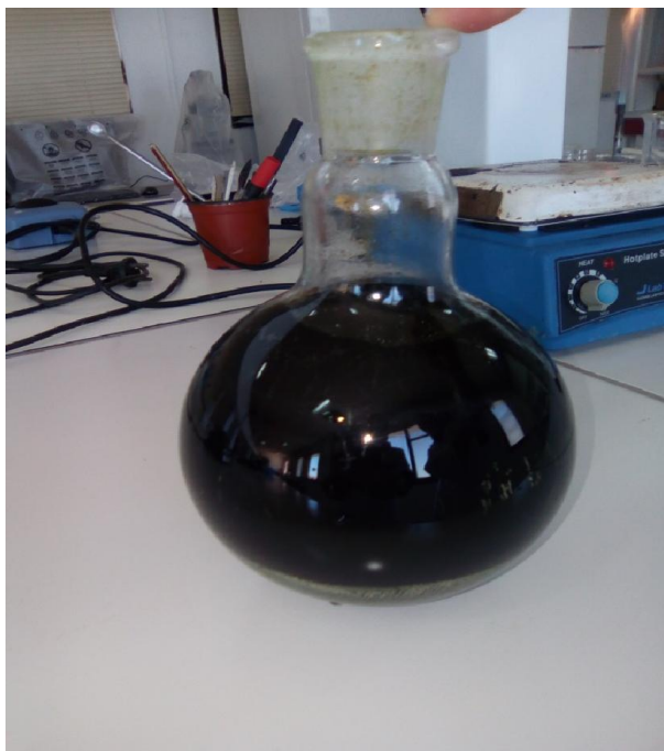
Figure 13 : l'extract obtenu après élimination du solvant pour calculer le rendement d'extraction (originale, 2017).
