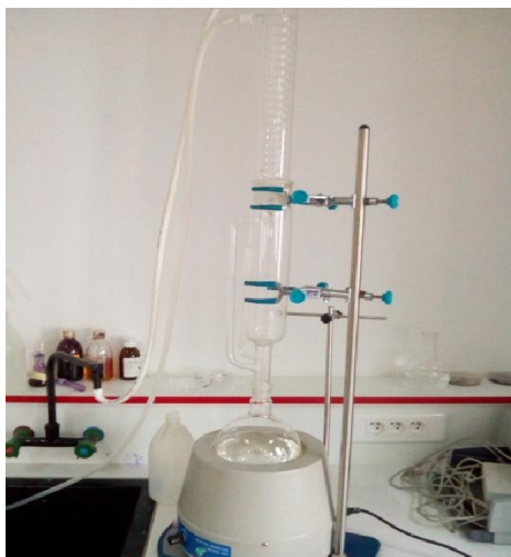
Figure 10: Montage de l'extraction Soxhlet (Originale, 2017).
