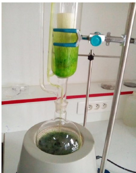
Figure 11 : Le retour du solvant contenant les principes actifs de l'extracteur vers le ballon (Originale 2017).
