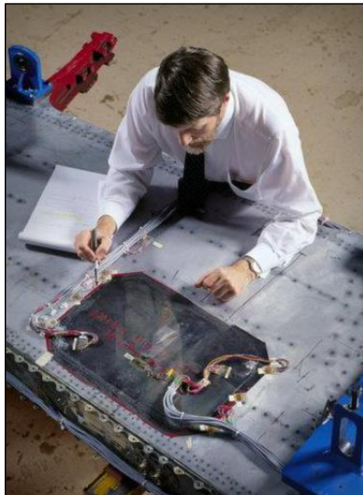
Figure I. 1. Technologie de réparation composite collée [1].
