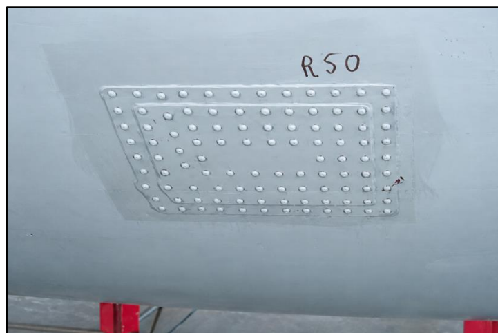
Figure I. 3. Réparation par patch riveté sur fuselage de Boeing [3].
