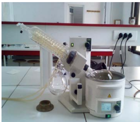
Figure n°24 Concentration des filtrats par le rotavaport
