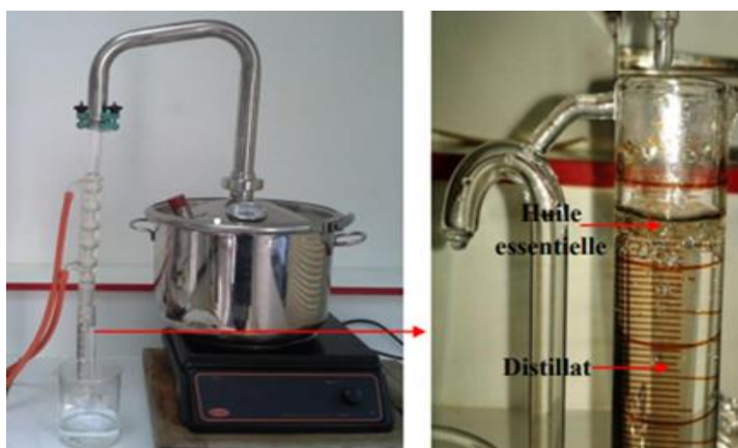
Figure 39 : Vapodistillateur de type SPRING A 105 12 Litres utilisé pour l'extraction des huiles essentielles de Laurus nobilis L
