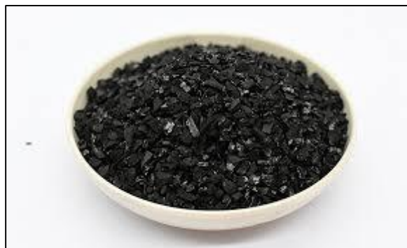
Figure 28 : Charbon actif en grain (CAG)
