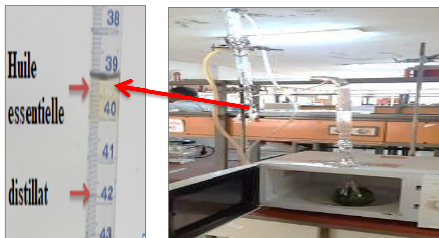
Figure 40 : Extracion de l’huile essentielles de feuilles laurus nobilis L par Hydrodistillation assisté par microonde
