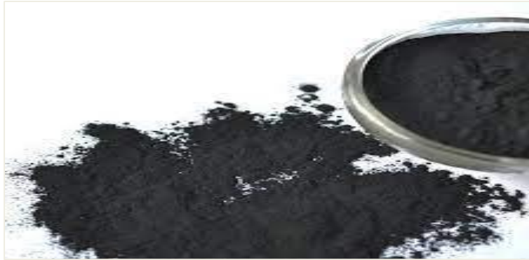
Figure 27 : Charbon actif en poudre (CAP)
