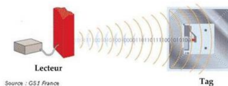
Figure I.6 : tag(s) passant dans la zone d'interrogation d'un lecteur portable
