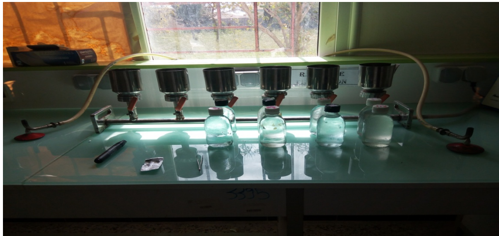
Figure II.4: photo présente la pompe sous vide pour filtrer les échantillons.
