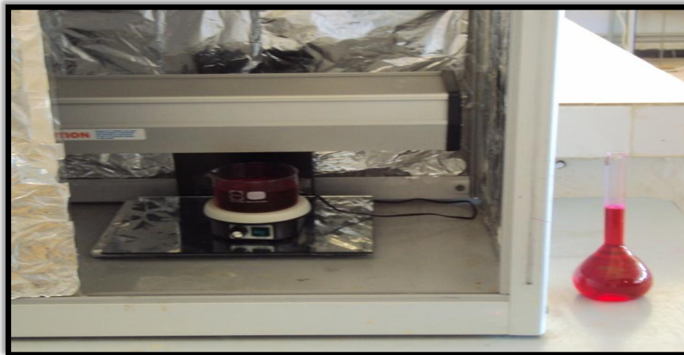
Figure III.3. Photographie du montage utilisé pour le traitement Fenton et/ou Photochimique
