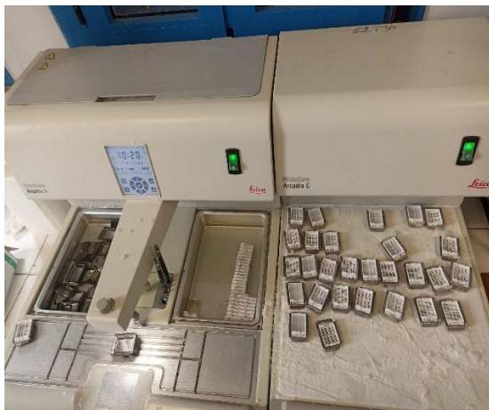
Figure 26 : Refroidissement les blocs sur plaque
