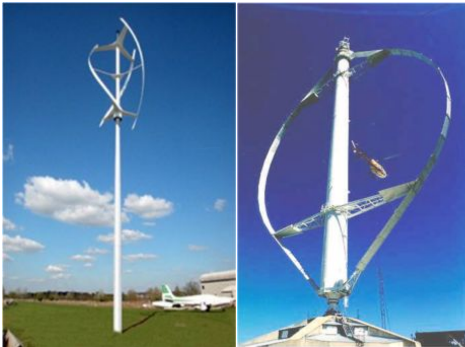
Figure I-7 : éolienne à axe vertical type darrieus
