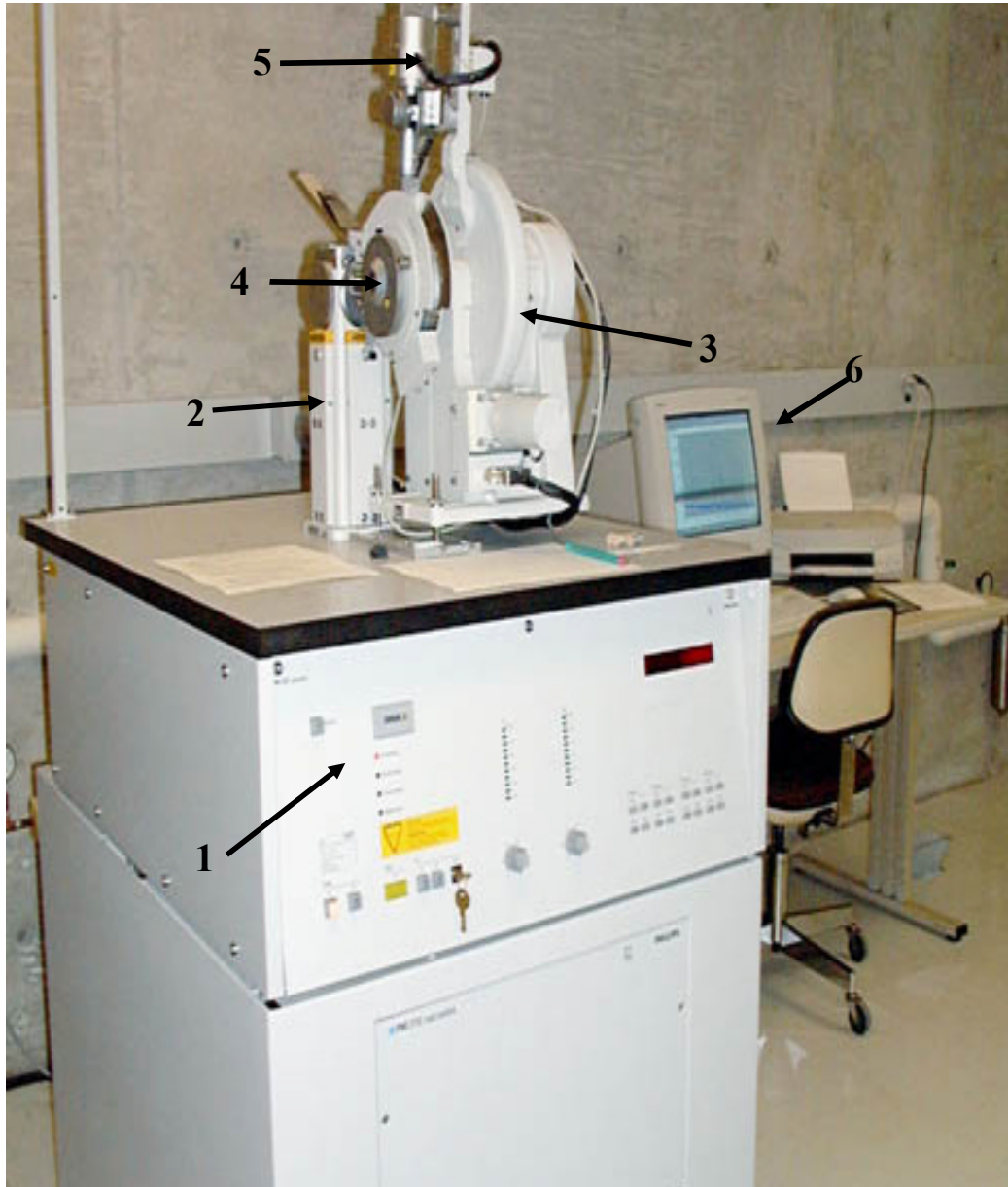
Figure (III.1): Le diffractomètre de poudres PW 3710.
