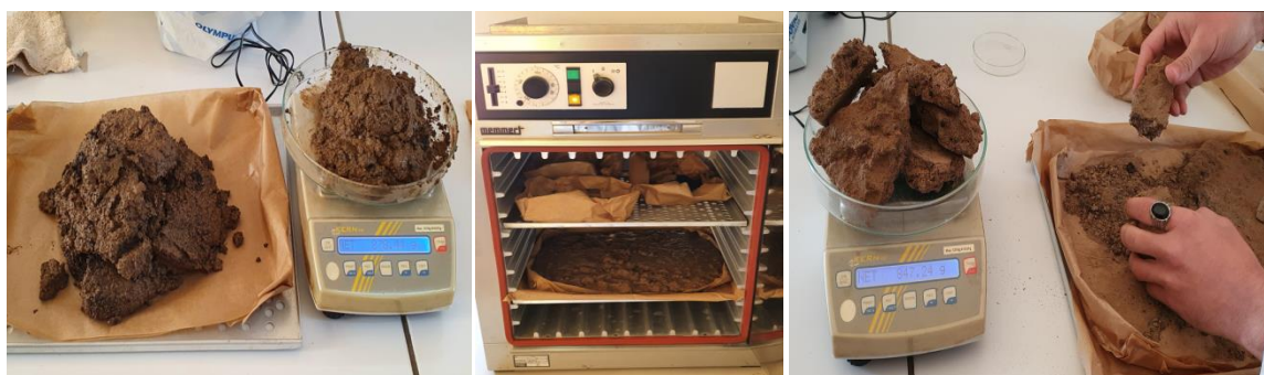
Figure n° 23 : mesure de capacité de rétention (Dibes.A et Mecelti.M.F ; 2023 )
