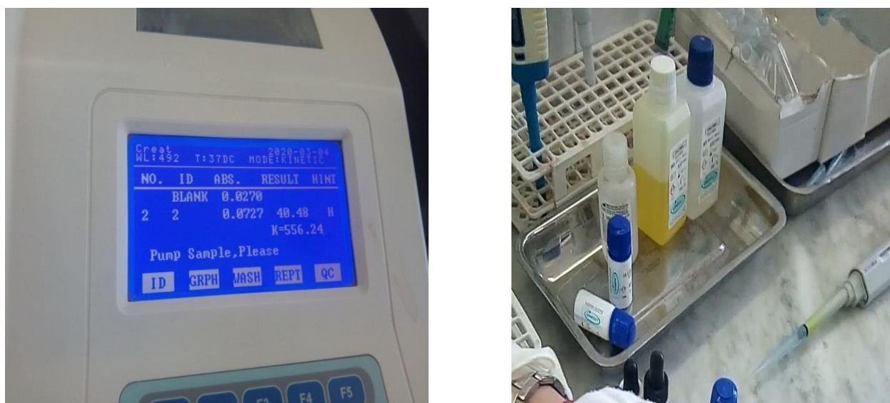
Figure 5: Spectrophotomètre et quelques réactifs utilisés dans les dosages colorimétriques
