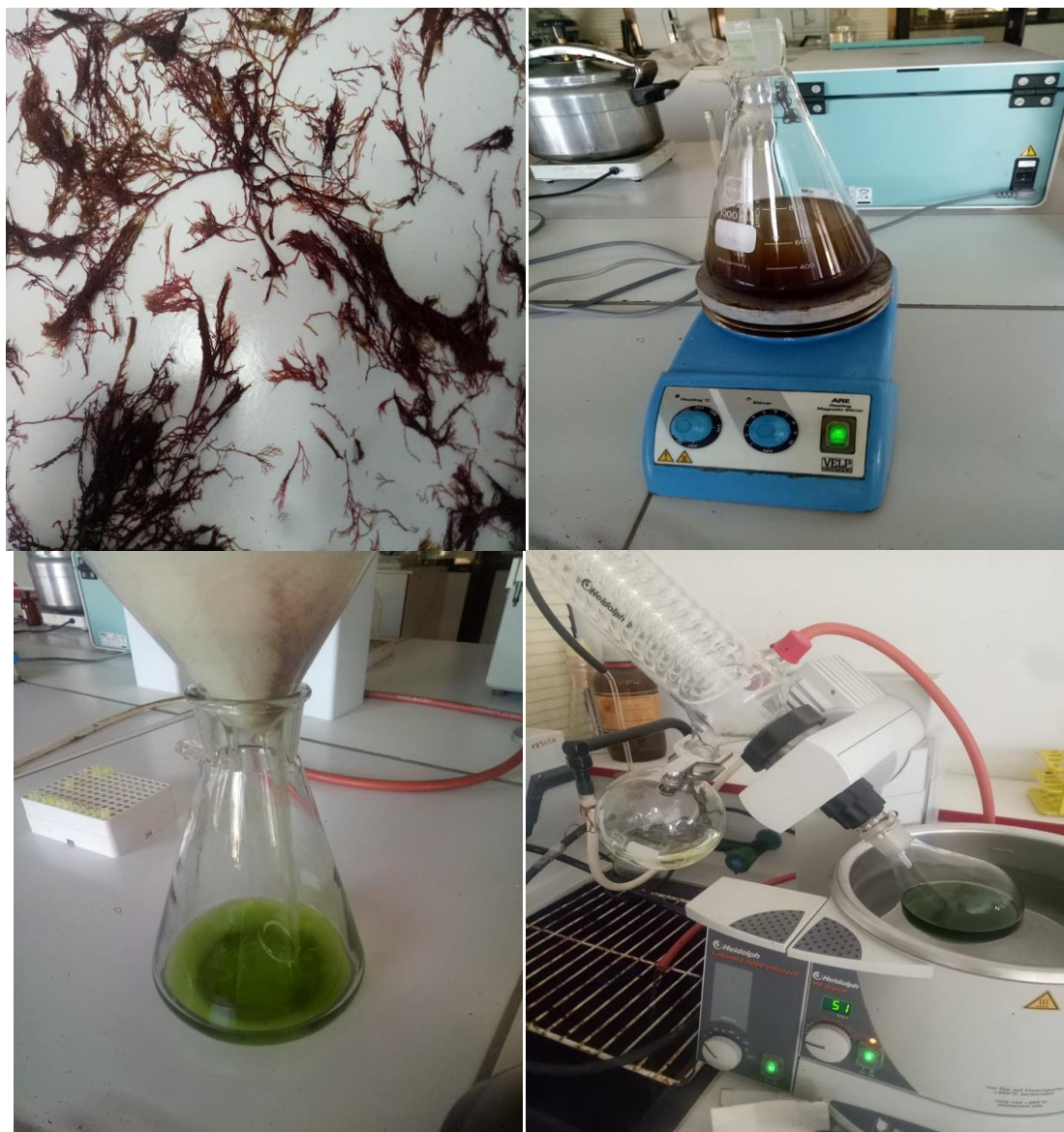
Figure 28: Les étapes pour obtenir l'extrait brut eau-méthanol de l'algue Rouge S.coronopifolius (Mehiaoui Saadia)
