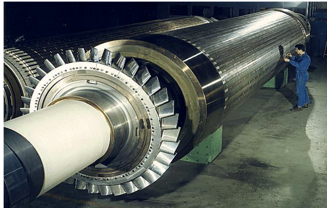
Figure I.9 : Rotor à Pôles lisses d'un alternateur haut tension [7]
