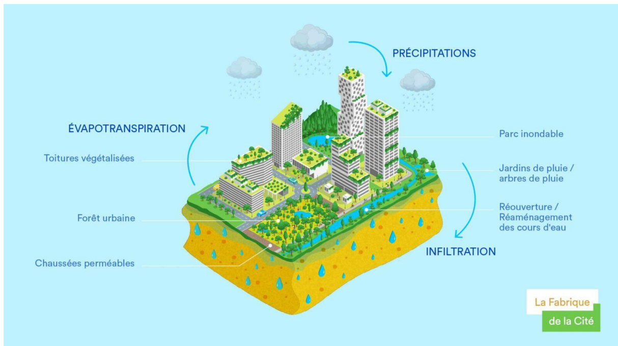
Figure 24: Schéma explicatif d'une ville éponge. Source : LA FABRIQUE DE LA CITE, Retour sur le programme des villes éponges chinoises, disponible sur : https://www.lafabriquedelacite.com/publications/retour-sur-le-programme-des-villes-eponges-chinoises/
