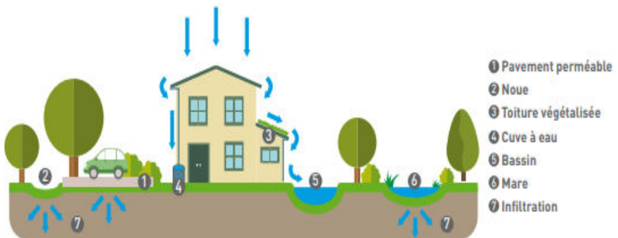
Figure 29 : Exemple de différentes techniques alternatives possibles pour gérer les eaux pluviales d'une maison. Source : SYMASOL, Gestion des eaux pluviales : Guide pour la mise en œuvre de techniques alternatives, 2016.
