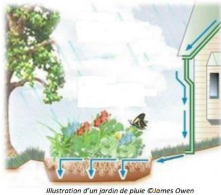
Figure 50 : Schéma d'un jardin de pluie. Source : TUTORIEL, Réaliser un jardin de pluie, 2021, disponible sur : https://www.loiret-nature-environnement.org/images/Zero_pesticide/Bienvenue/Am%C3%A9nager_un_jardin_de_pluie_-_BMJN_2021.pdf
