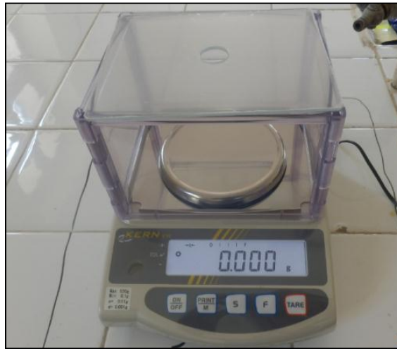
Fig. 23 : Balance de précision de la marque KERN EW de précision (0,001g).
