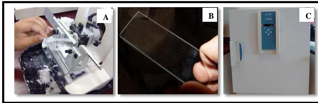
Planche 4 : Réalisation des coupes fines ; A : Microtome ; B : lame ; C : Etuve.
