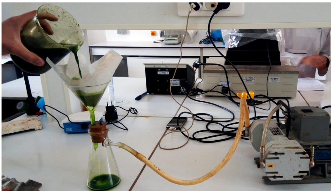
Figure. La filtration en utilisant un papier filtre Whatman (0,2 \mu m).
