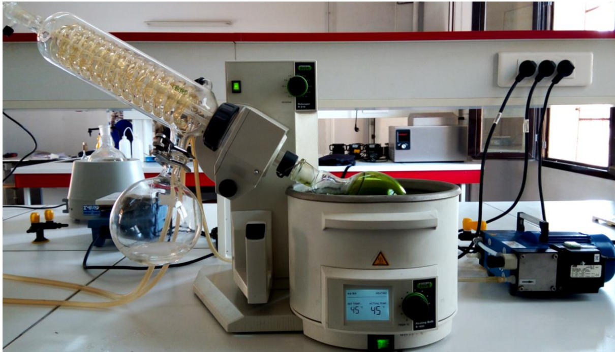
Figure. L'évaporation sous vide à 45 °C au l'évaporateur rotatif.
