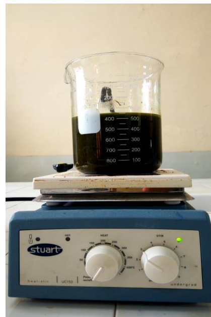
Figure. Procédure d'agitation (durant 6 heures à température ambiante).
