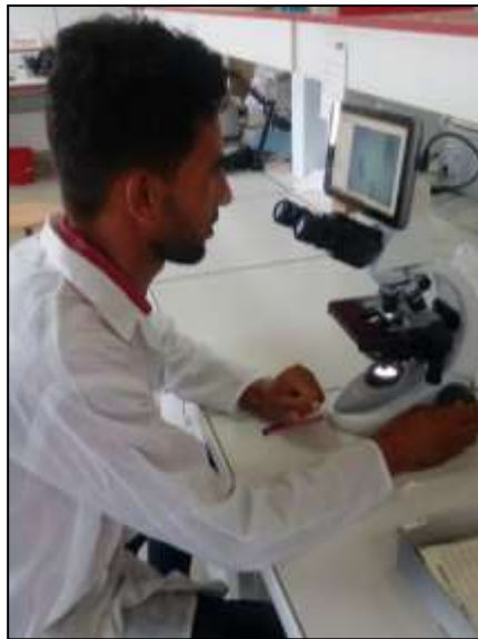
Figure 14 : Prise de photos de sclérites à l'aide d'une tablette intégrée au microscope photonique.
