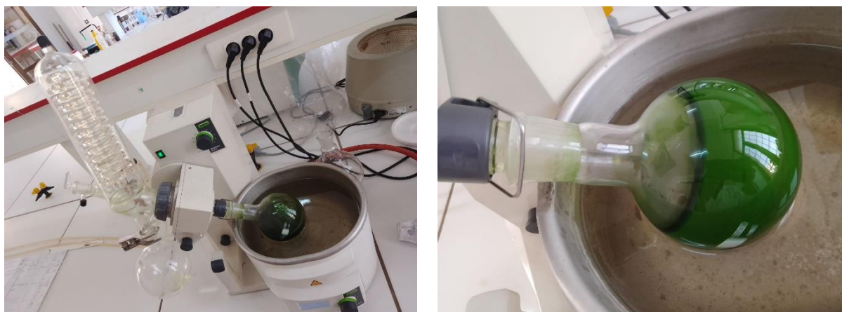
Figure27: L'étape d'évaporation du solvant méthanoïque par le rotavapeur (Photo originale, 2025)
