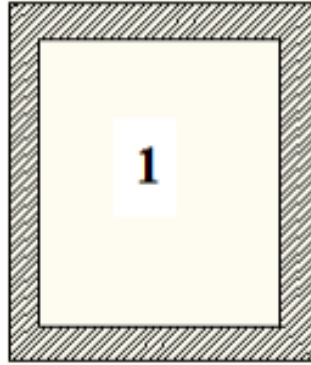
Figure III-13 : Panneau intermédiaire appuyé sur 4 cotés.
