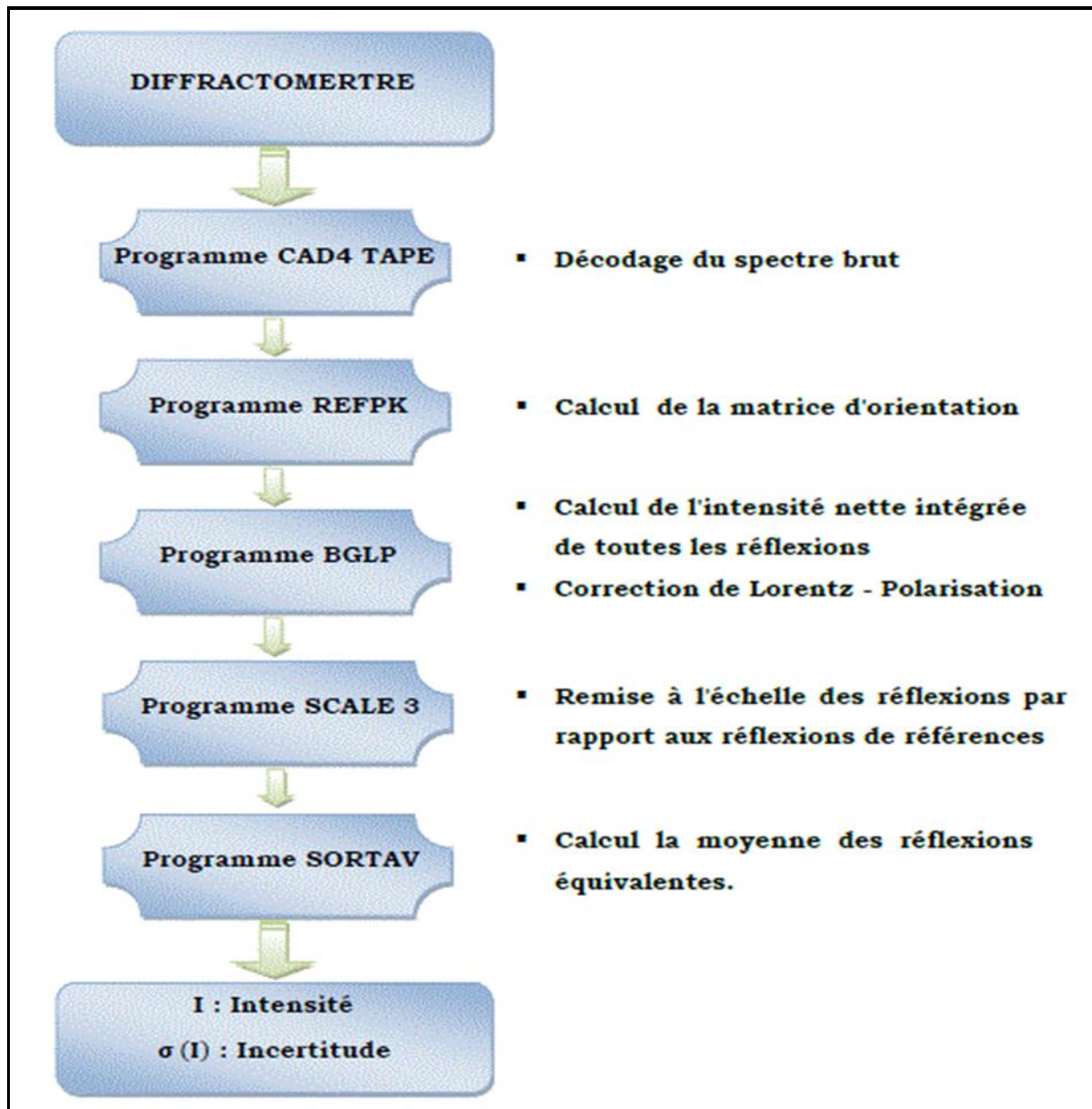
Schéma I.2. Programmes utilisés pour les traitements des données d'après le formalisme de Blessing
