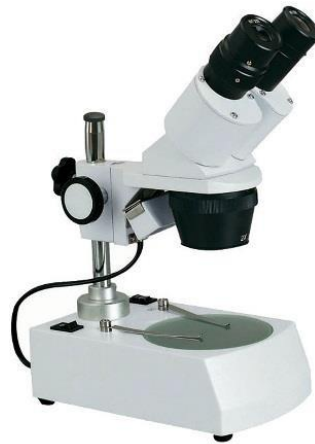
Figure. I.8. Microscope optique binoculaire pour le choix du monocristal
