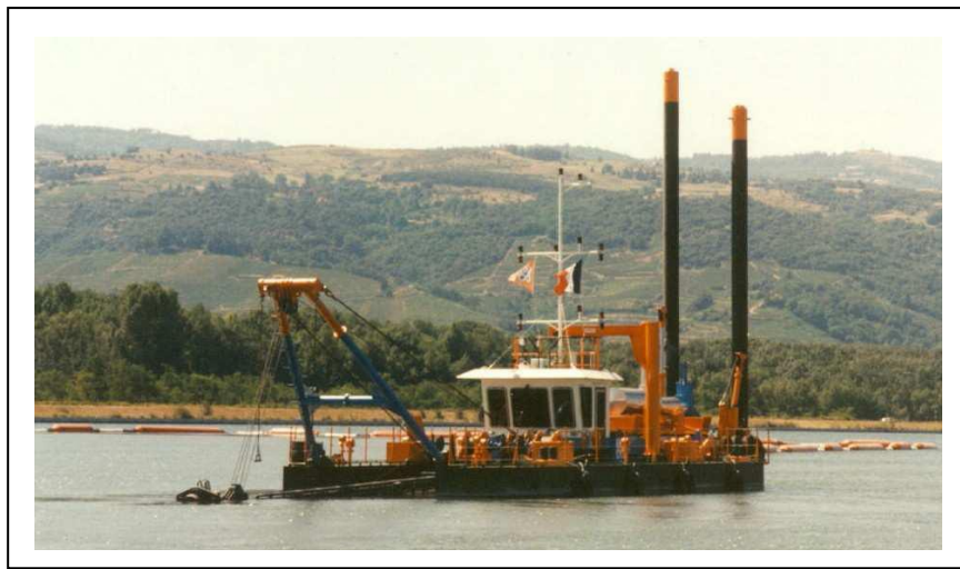
Figure I.5: Aspiratrice stationnaire avec conduite de refoulement [Ministère de l'Ecologie et de l'Energie ,2009]
