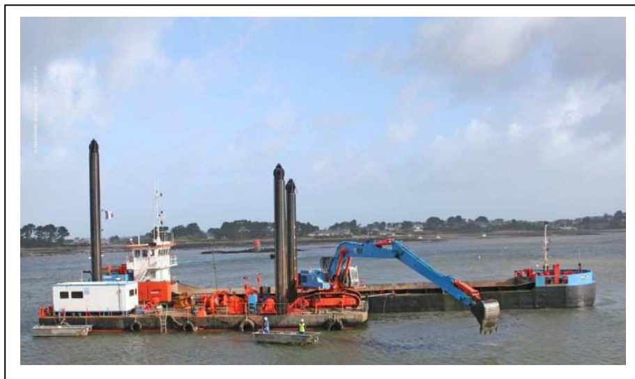
Figure I.3: Drague à pelle [Ministère de l'Ecologie et de l'Energie ,2009]
