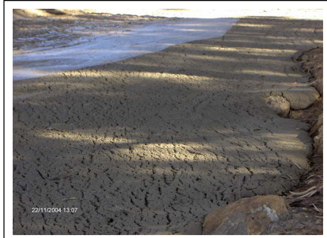
Figure I.9: Ecoulement de la vase à sa sortie d'une vidange de fond. (Barrage de Fergoug)[Semcha, 2006].
