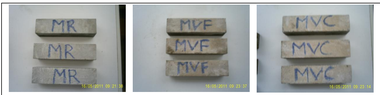
Figure IV.30 : Les mortiers normalisés après démoulage
