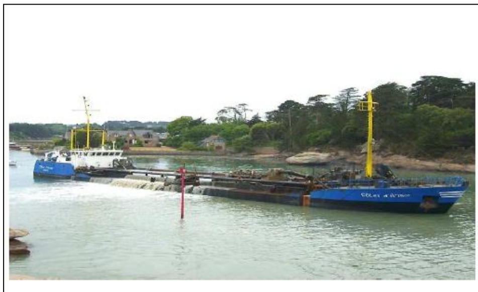
Figure I.6: Aspiratrice en marche [Ministère de l'Ecologie et de l'Energie, 2009]
