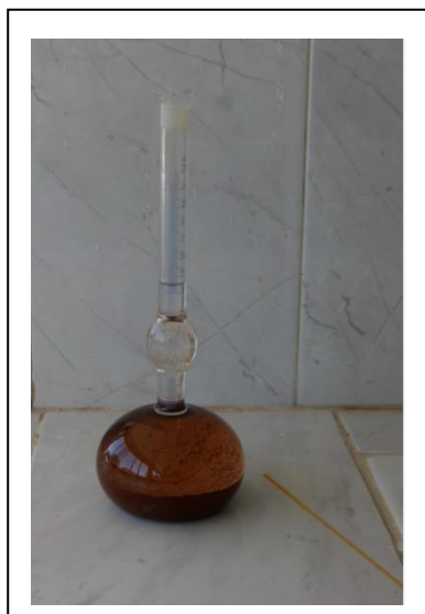
Figure IV.2 : Mesure de la masse volumique absolue de la vase calcinée par l'appareil " Le Chatelier ".
