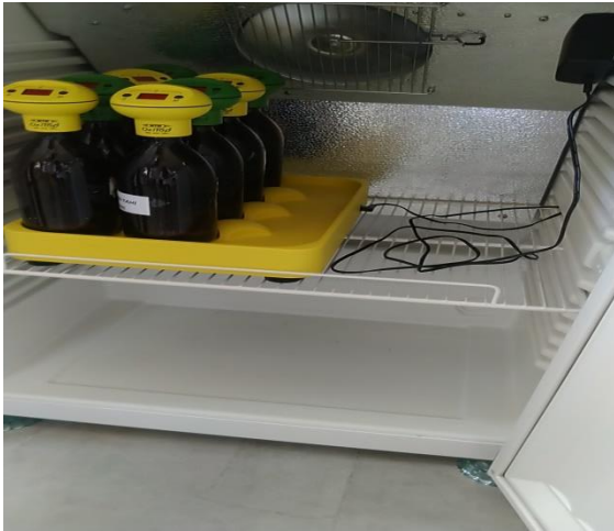
Figure III.9: Les flacons de la DBO5
