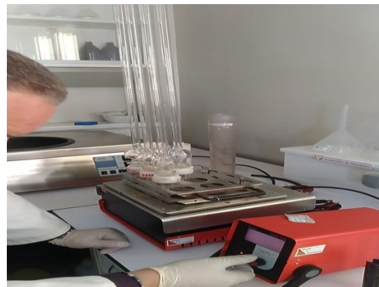
Figure III.12 : un minéralisateur à 150° C
