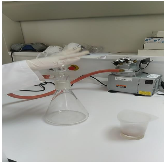
Figure III.8 : dispositif de filtration
