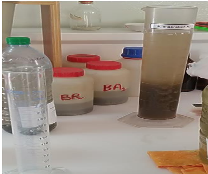
Figure III.17 : décantation après 30 min « V_{30} »
