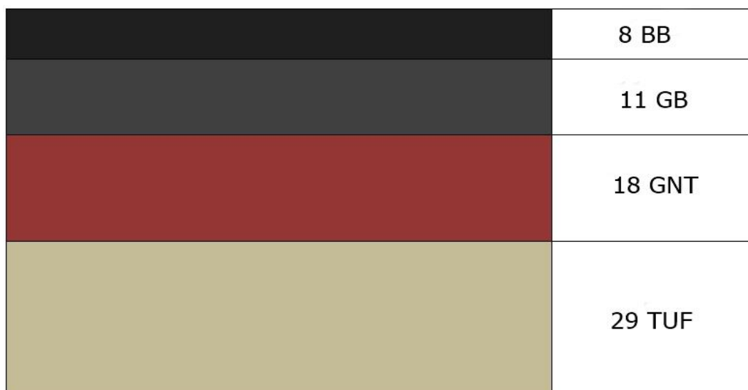
Figure N°11 : Différentes couches du corps de chaussée
