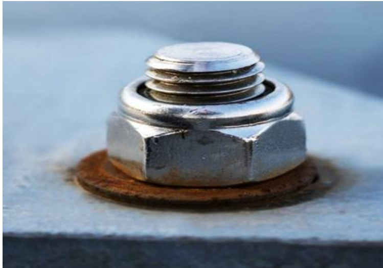
Figure III.6 : Perte de métal due à la corrosion galvanique
