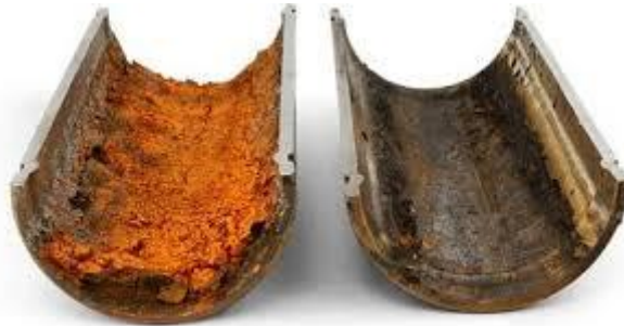
Figure III.3 : Corrosion interne du métal
