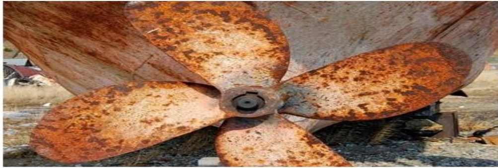
Figure III.7 la corrosion sélective
