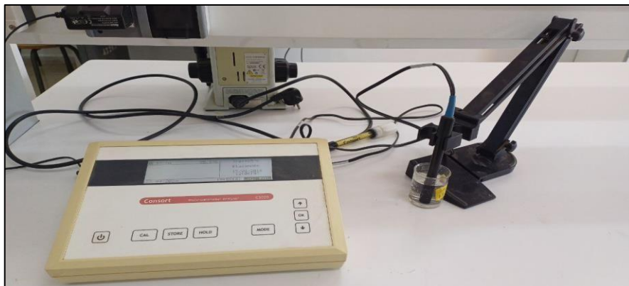
Photo 6 : Mesure de la conductivité électrique du sol par le conductimètre ( Merzougui, 2025 ).
