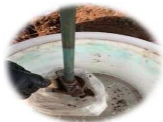
Photo 11 : Mesure de la densité apparente à l'aide de cylindre (Merzougui, 2025).
