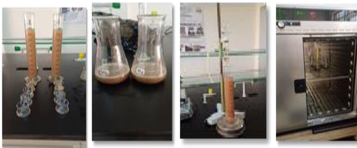
Photo 4: Analyse granulométrique par la méthode de la pipette de Robinson (Merzougui, 2025).
