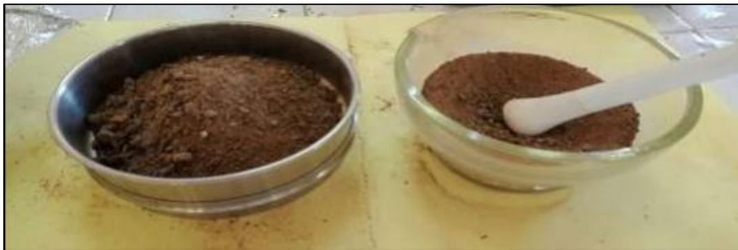
Photo 3: Broyage et tamisage des échantillons de sol (Merzougui, 2025).
