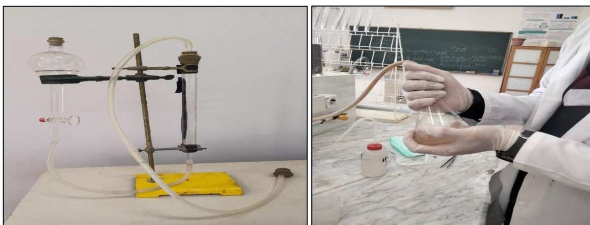
Photo 7 : Dosage du calcaire total ( Merzougui, 2025 ).
