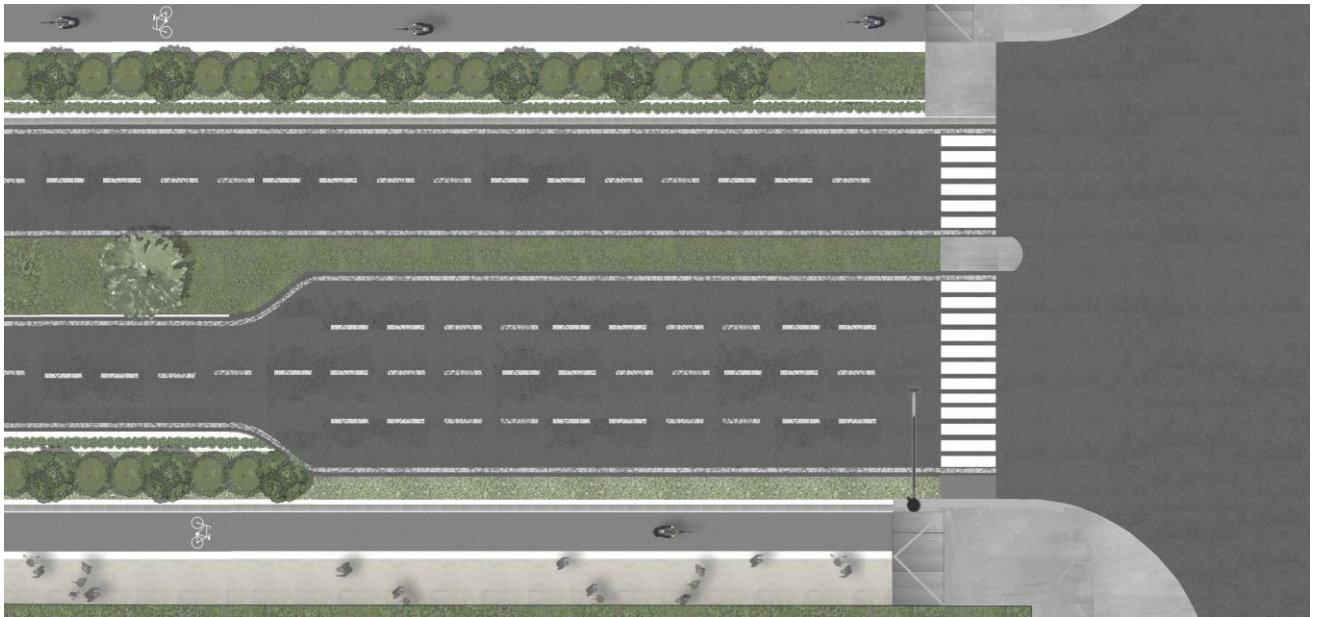
Figure 45 : Plan du carrefour type
