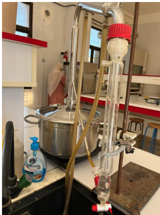
Figure 26: Dispositif de l'hydrodistillation (Université de Mostaganem)
