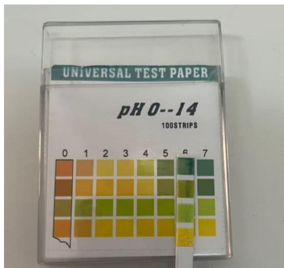
Figure 30: Détermination du pH de l'échantillon par bandelette indicatrice universelle.
