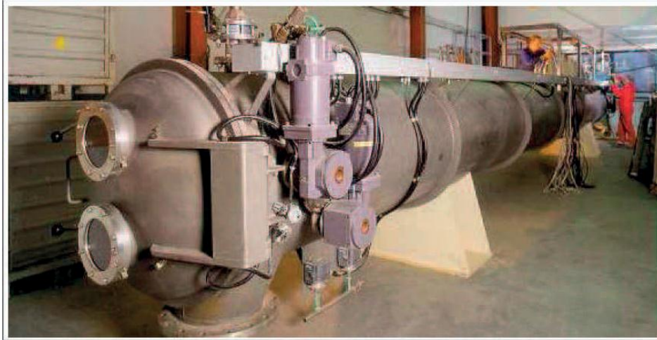
Figure 07 : Séchage des fruits tropicaux sous vide assisté par micro-ondes (Virot, 2009).
