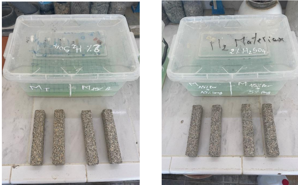
Fig. V.16 : Aspect visuel des échantillons après 64 jours de conservation dans la solution en 2\%H_2SO_4 .
