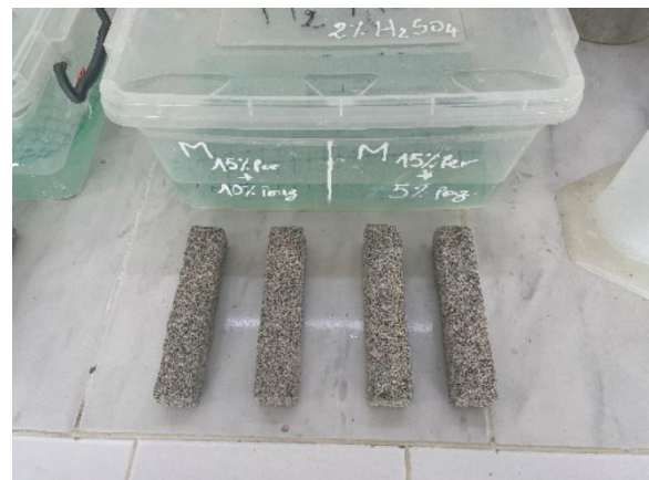
Fig. V.15 : Aspect visuel des échantillons après 57 jours de conservation dans la solution en 2% H_2SO_4 .
