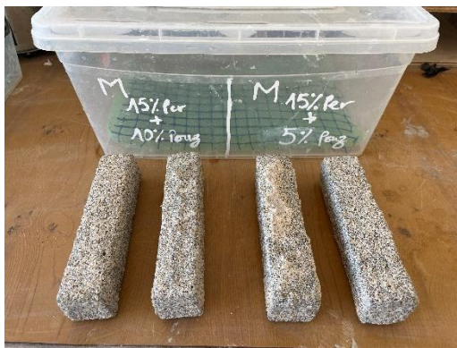
Fig. V.14 : Aspect visuel des échantillons après 45 jours de conservation dans la solution en 2% H_2SO_4 .
