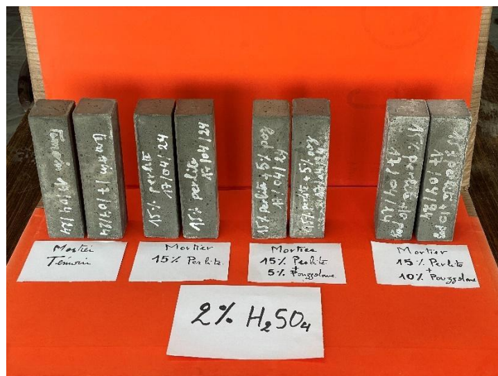
Fig. V.3 : Échantillons du mortier avant immersion dans les solutions acides.
