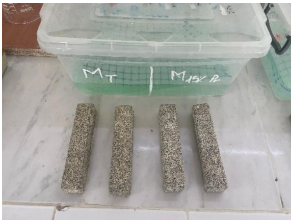
Fig. V.15 : Aspect visuel des échantillons après 57 jours de conservation dans la solution en 2% H_2SO_4 .
