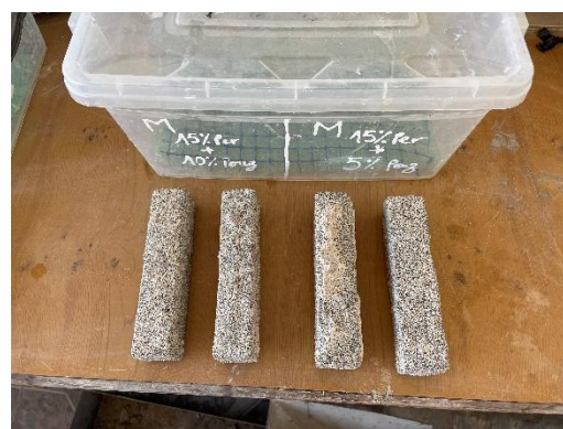
Fig. V.14 : Aspect visuel des échantillons après 45 jours de conservation dans la solution en 2% H_2SO_4 .
