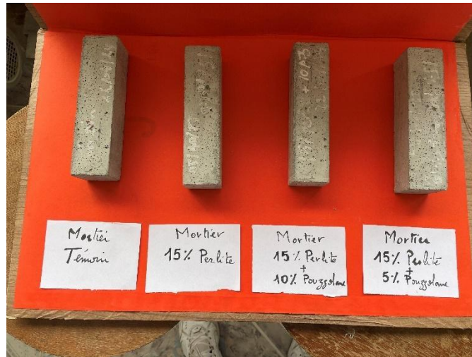
Figure V.4 : Les éprouvettes destinées à l'essai de carbonatation naturelle
