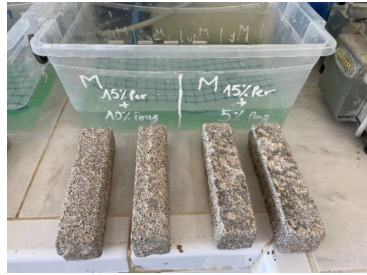
Figure. V.13 : Aspect visuel des échantillons après 30 jours de conservation dans la solution en 2% H_2SO_4 .
