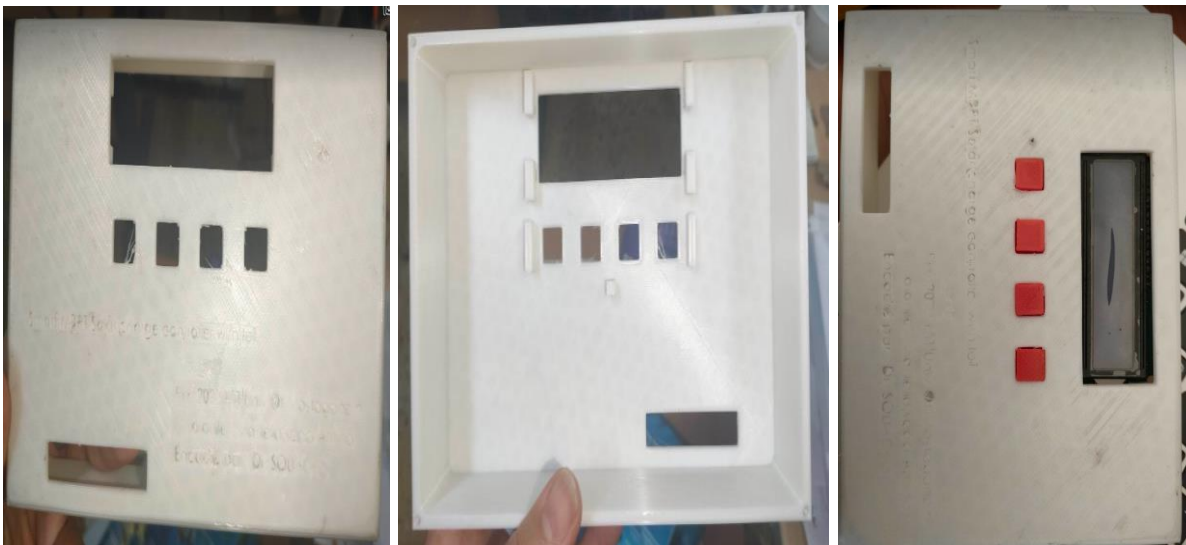
Figure V.12 : L'impression du boîtier à travers imprimante 3D
