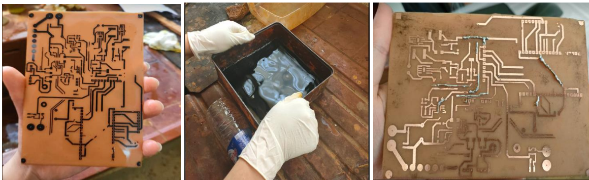
Figure V.4 : utilisation du chlorure de fer pour la fabrication du PCB
