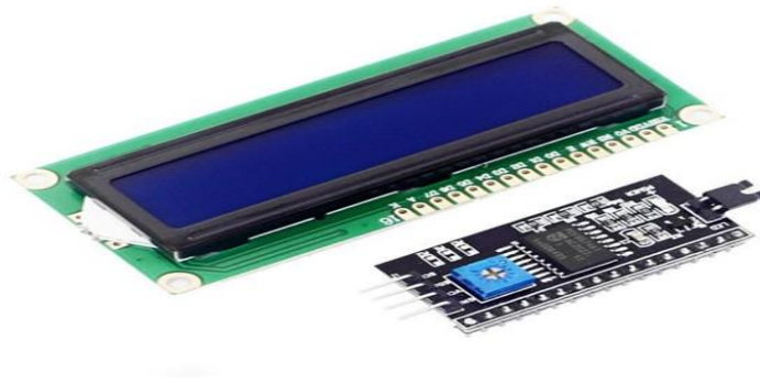
Figure VI.25 : Structure d'un écran LCD-(16*2) avec I2C.
