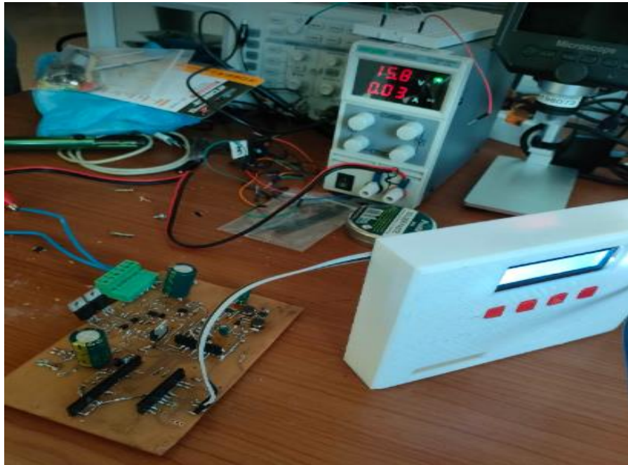
FigureV.10 : test de LCD i2c avec circuit imprimé
