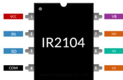
IR2104 MOSFET Pinout
