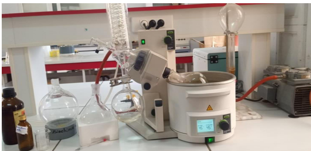
Figure 12 : Rotavapor (évaporation du solvant sous vide à 45C°)
