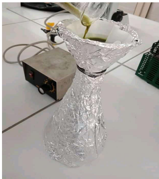
Figure 10 : Filtration en utilisant un papier filtre Whatman N°1
