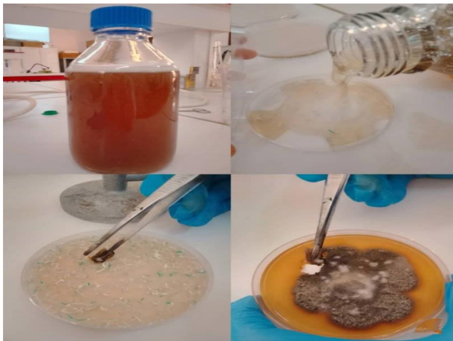
Figure 19 : Les différentes étapes de la première méthode de test de biodégradation.
