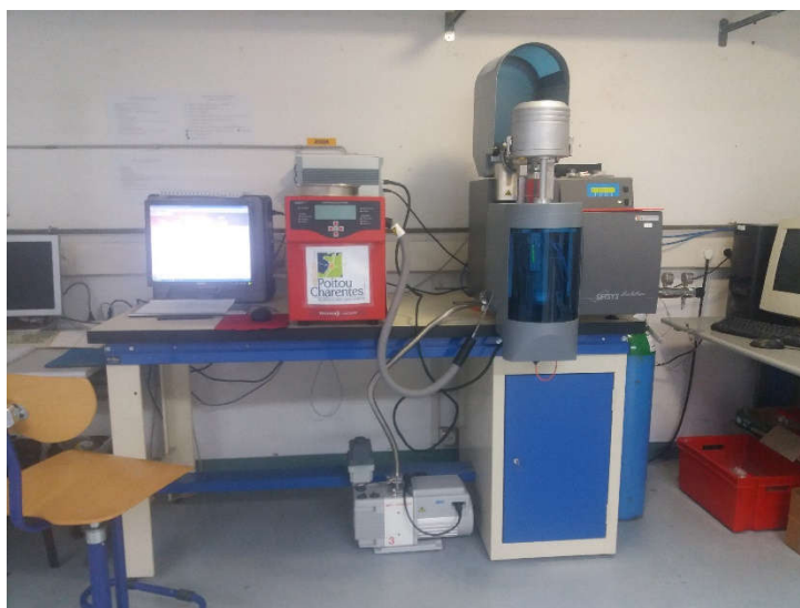
Figure 2. 8 : Appareil d'analyse thermogravimétrique (ATG) (laboratoire des Sciences de l'Ingénieur pour l'Environnement (LaSIE) à l'université de La Rochelle, France.
