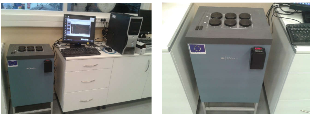
Figure 2. 10 : Calorimètre isotherme multicanal (Laboratoire GeM à l'école centrale de Nantes, France).
