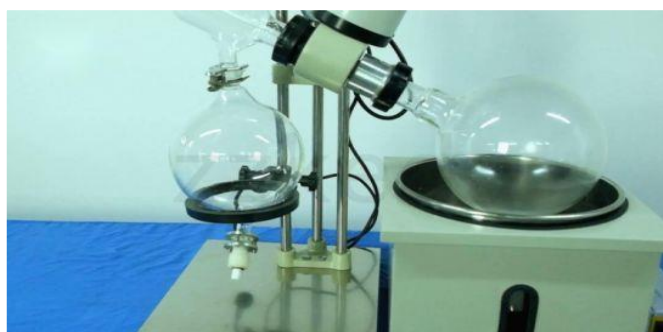
Figure 28 : Evaporation sous vide par le rotavapeur
