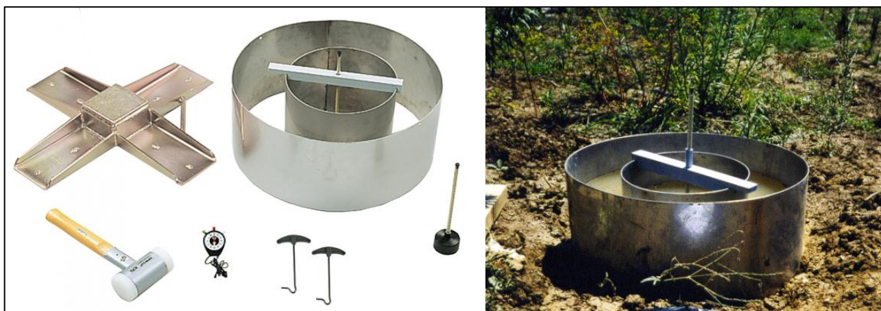
Figure 25: Dispositif de Muntz à double anneau pour la mesure de l'infiltration
