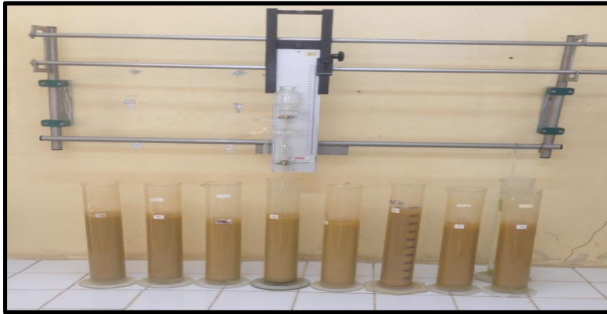
Figure 04 : La pipette de Robinson (RAHRAHI boualem, 2019)
