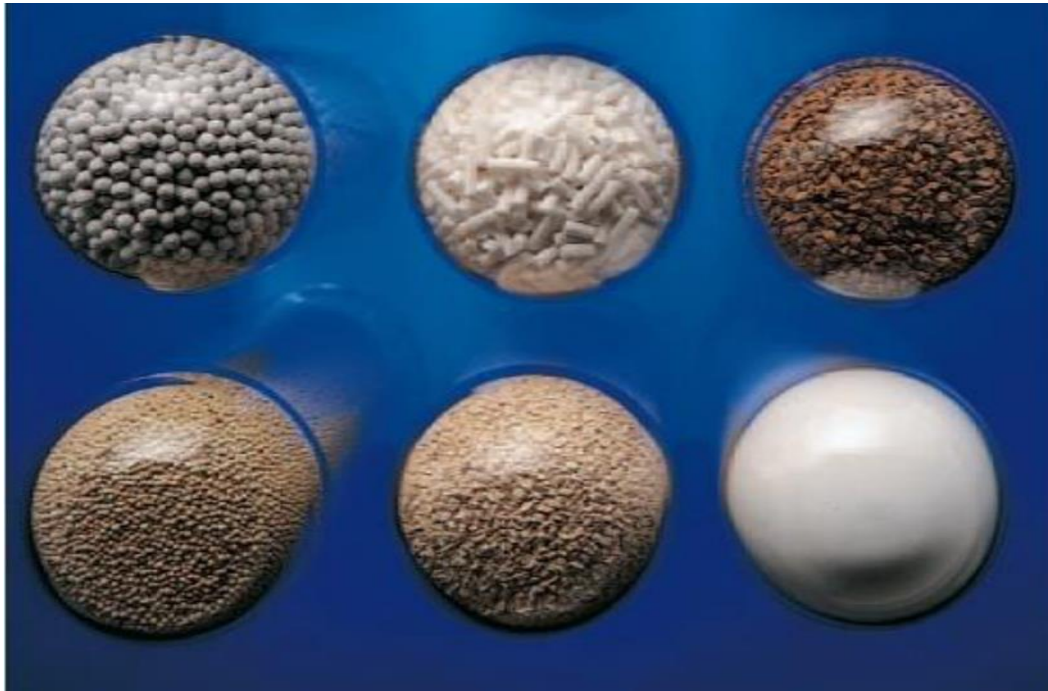
Figure II.6. Différentes formes des tamis moléculaire
