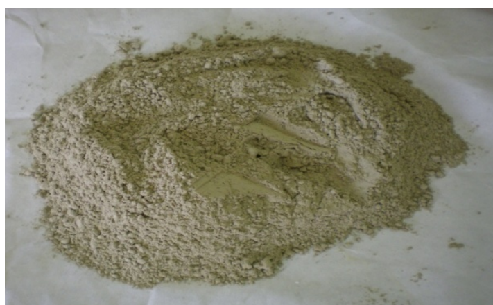
Figure 1. Bentonite en poudre.
