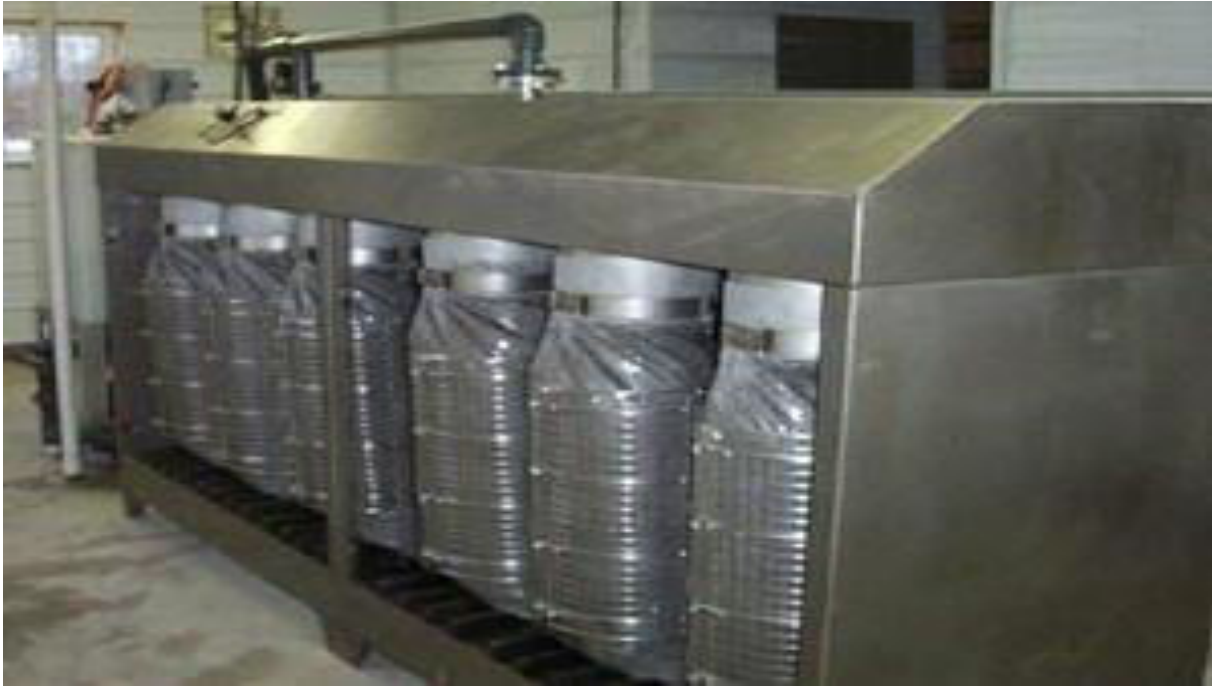
Figure II.5 : DRAIMAD (Déshydratation des boues)
