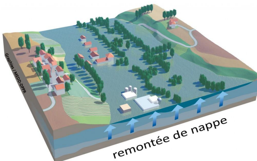
Figure 14: Remontée de nappe
