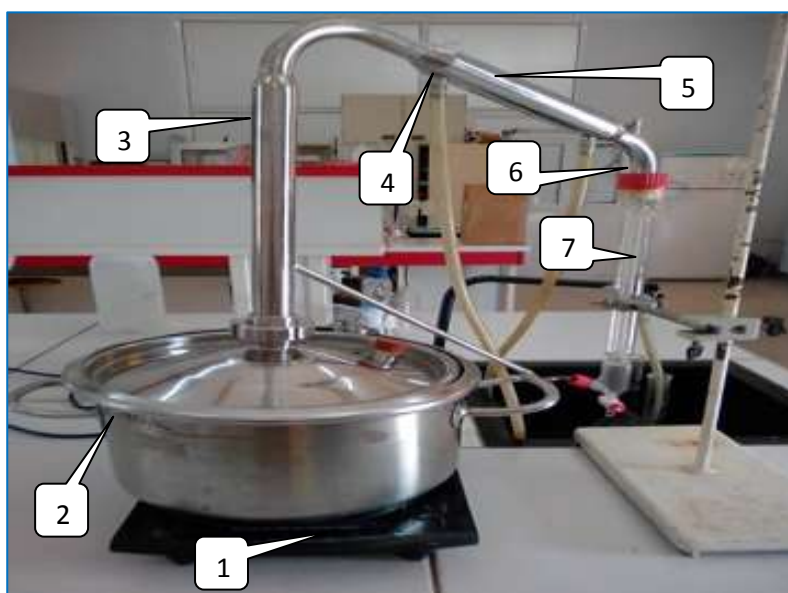
Figure 12: Montage d'entraînement à la vapeur d'eau, 1: plaque chauffante, 2: cocotte minute 3: condensateur, 4: sortie de l'eau, 5: réfrigérant, 6: entrée de l'eau et 7: tube gradué (Originale, 2019).
