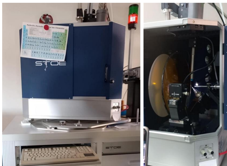
Figure III.4. Équipement expérimental d'un diffractomètre STOE IPDS II.
