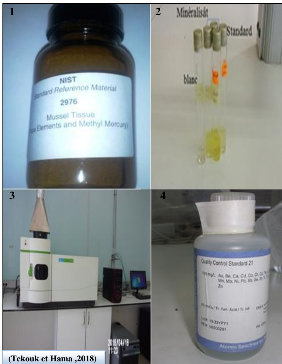
Figure 25 : Etapes du dosage par S.E.O, 1: Echantillon de l'inter calibration de la moule fourni par NIST, 2 : série de minéralisation ,3 : l'appareille spectrophotométrie émission optique SEO, 4 : standard multiélément de 21 éléments.
