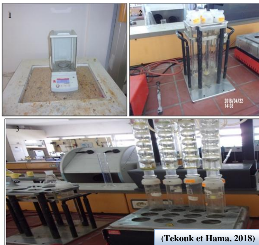
Figure 23 : Etapes de la minéralisation ; 1 balance à précision ; 2 les matras avec les échantillons ; 3 les matras avec réfrigèrent.
